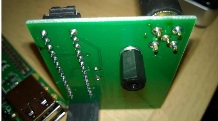
Dann die Aufsteckplatine ganz am Rand auf den Raspberry PI B+ aufstecken. Und bitte unbedingt auch gleich eine Antenne mit SMA-Anschluss aufschrauben.
