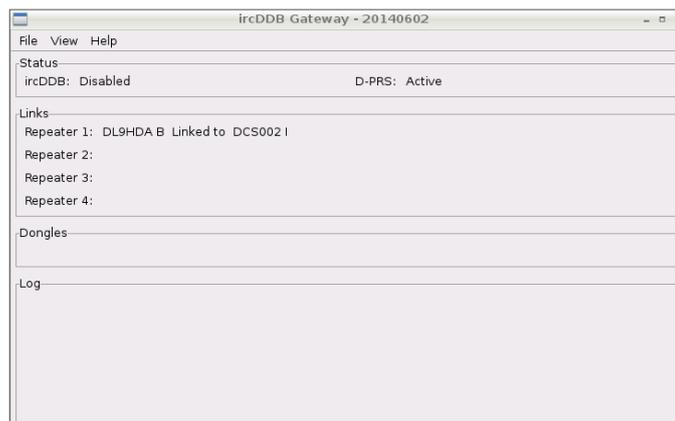
Im Fenster der Software *D-Star Repeater* wird der Link-Status unter *Gateway* mit dem ausgegebenen *Ack Text* angegeben.
